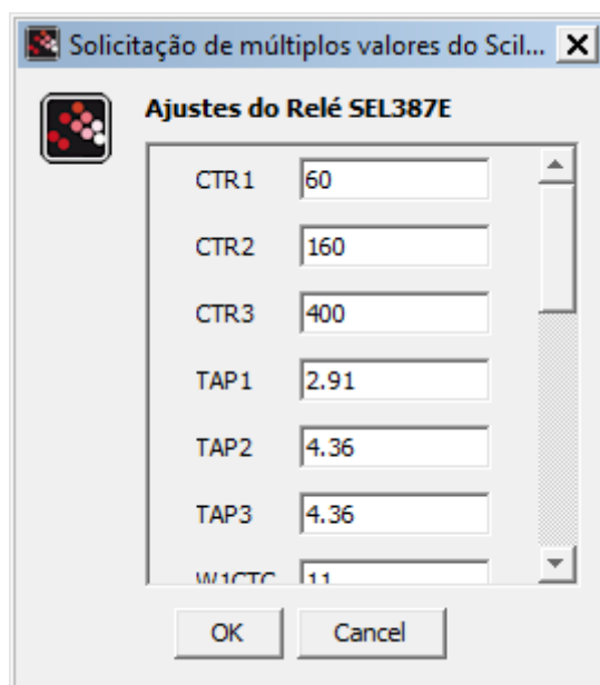
Figura 6.2 – Janela de entrada de ajustes do relé diferencial
