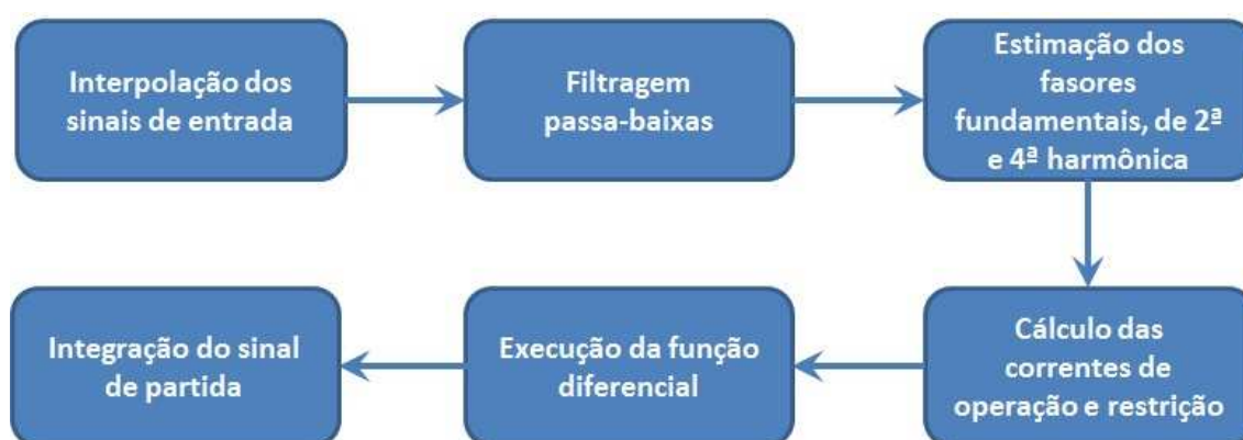
Figura 4.21 – Sequência de operações executadas na função que modela o comportamento do relés diferencial de transformador
