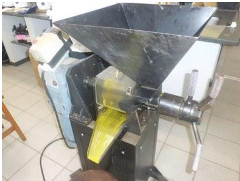
Figura 23- Prensa Mecânica Utilizada na extração do óleo de macaúba
