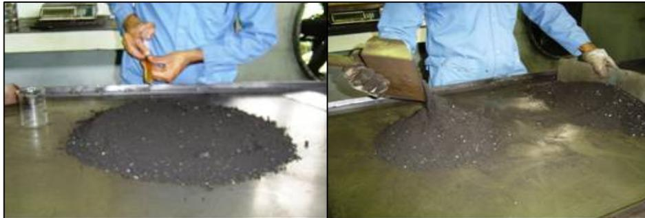
**Figura 14:** Adição de óleo e homogeneização da amostra
