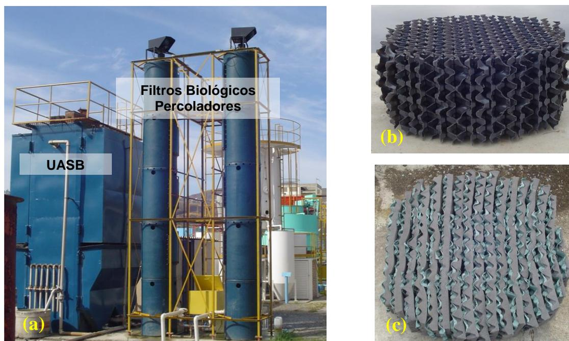
**Figura 4.3** – Fotos do sistema UASB-FBP: (a) reator UASB 2 e FBP; (b) material de enchimento *rotopack*; (c) material de enchimento *rotosponge*
