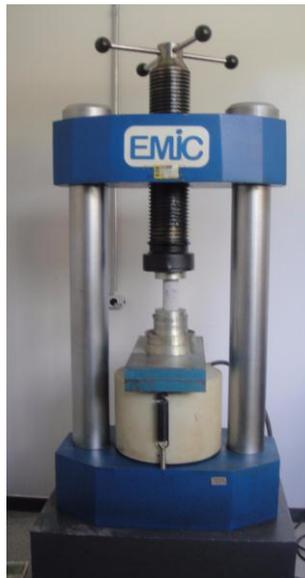
Figura 3.8 — Equipamento utilizado no ensaio de resistência à compressão.
