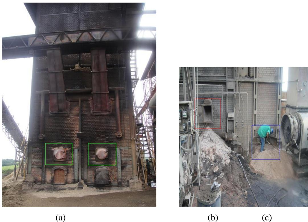
Figura 3.3 — Vista frontal da caldeira: fornalha (a). Vista lateral direita da caldeira: cinzeiro (b) e pré-ar (c). Dessas regiões são retiradas as cinzas pesadas.
