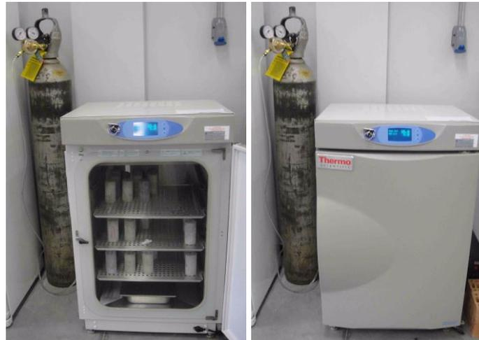
Figura 3.11 — Câmara de carbonatação com cilindro de CO<sub>2</sub>.
