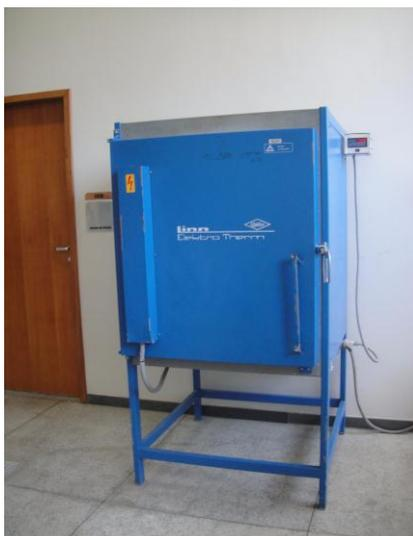
Figura 3.12 — Forno utilizado para requeimar a cinza do exaustor a 700°C durante 90 minutos.
