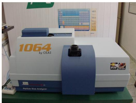
Figura 3.6 — Granulômetro a laser.
