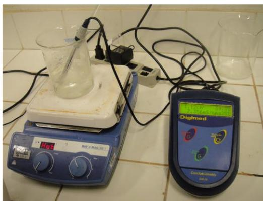
Figura 2.1– Equipamento utilizado no ensaio de condutividade elétrica.
