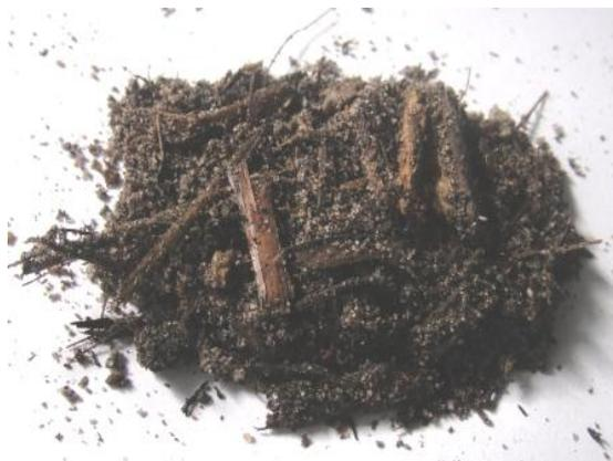
Figura 4.2 — Cinza proveniente da fornalha com fibras de bagaço de cana-de-açúcar não queimadas.
