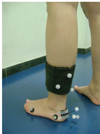
FIGURA 13: Clusters com marcas de rastreamento para a perna e calcâneo, com a inclusão de duas marcas técnicas laterais para definição da fase de apoio.
