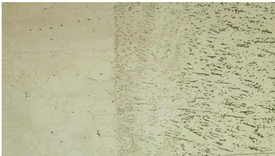
Figura 5.4 - Microestrutura da ZAT 2. Ataque: Ácido oxálico 10%. Ampliação original 200 vezes.
