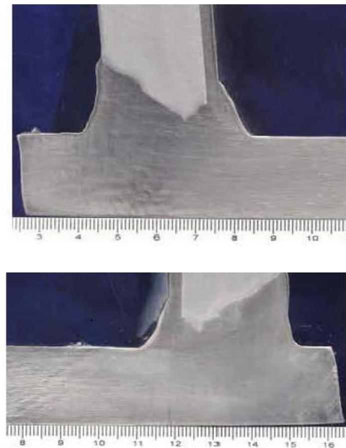
Figura 5.1 – Macroestrutura da junta. Peça horizontal: aço carbono caldeado. Peça vertical: aço inoxidável austenítico. Ataque: Marble
