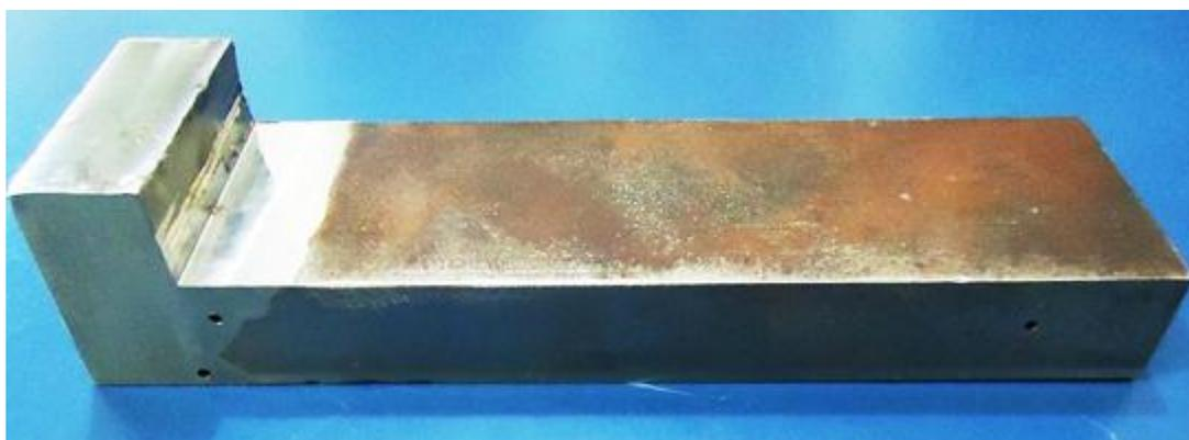
Figura 4.3 – Foto do bloco padrão para calibração da sensibilidade do ensaio por ultrassom retirado da peça A.
