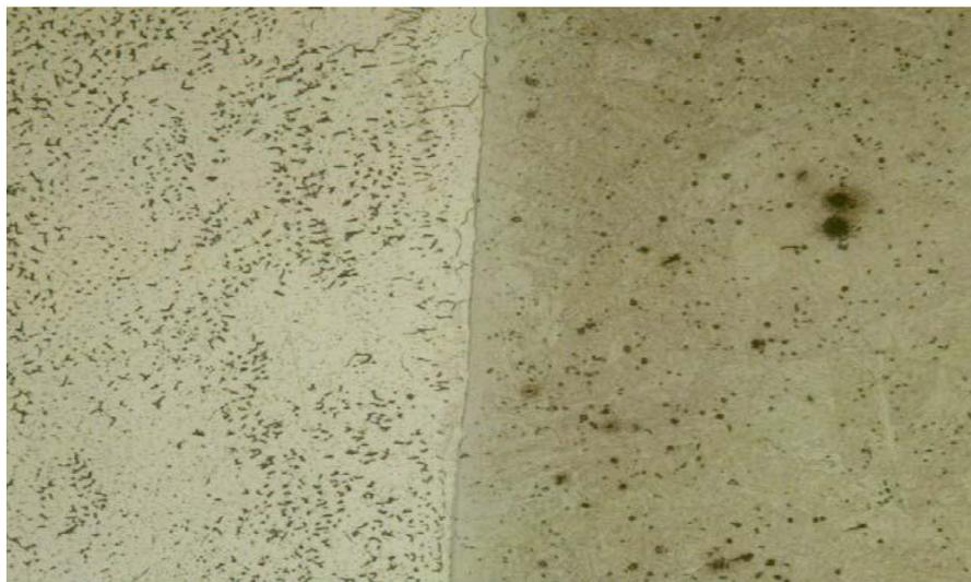
Figura 5.3 - Microestrutura da ZAT 1. Ataque: nital 3%. Ampliação original 200 vezes.
