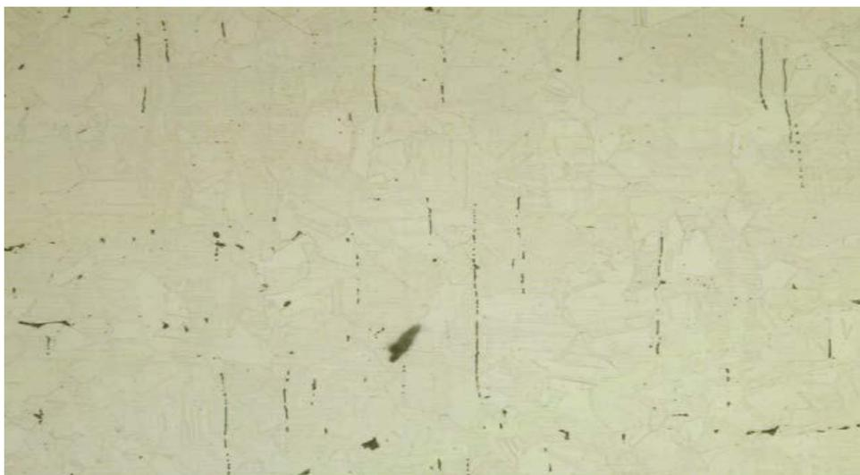
Figura 5.6 Microestrutura do MB 2. Ataque Eletrolítico: Ácido oxálico 10%. Ampliação original 200 vezes.
