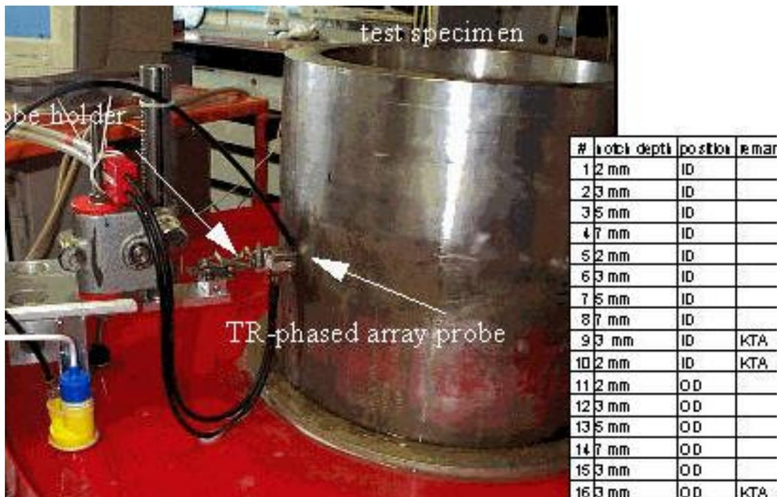
Figura 3.22 - Esquema experimental para a atualização do ensaio<sup>(16)</sup>.
