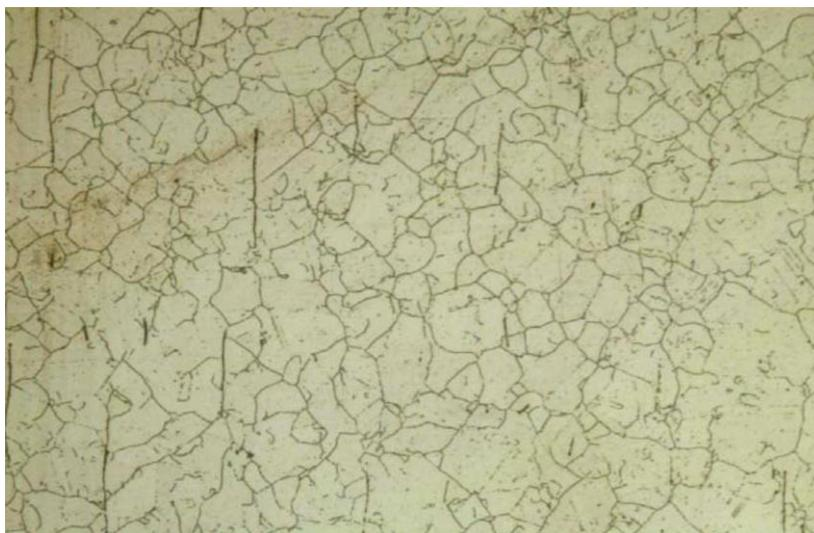
Figura 5.7 - Resultado do teste de corrosão intergranular. Ataque: Ácido oxalático 10% eletrolítico. Ampliação 200 vezes.
