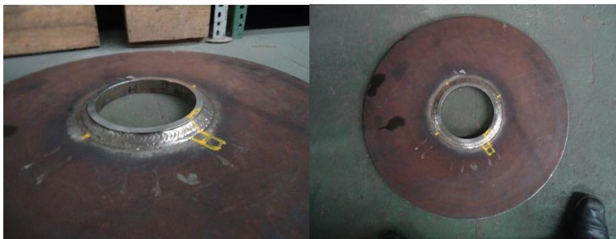
Figura 4.5 - Peça B após o corte do tubo rente à junta soldada
