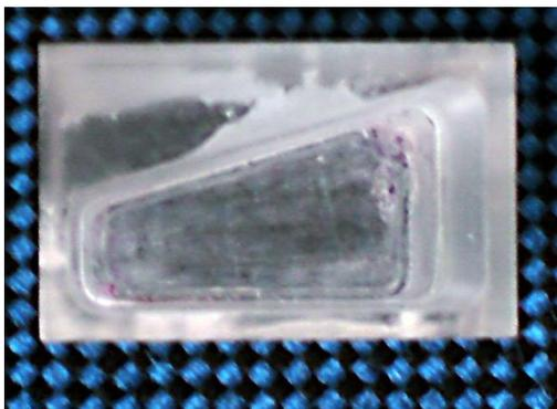
Figura 5.16 – Sapata de acrílico preenchida com água.
