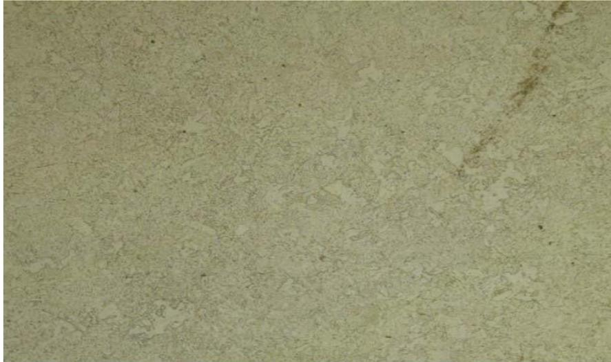
Figura 5.2 - Microestrutura do MB1 (aço carbono) - ataque nital 3%, ampliação original de 200 vezes.
