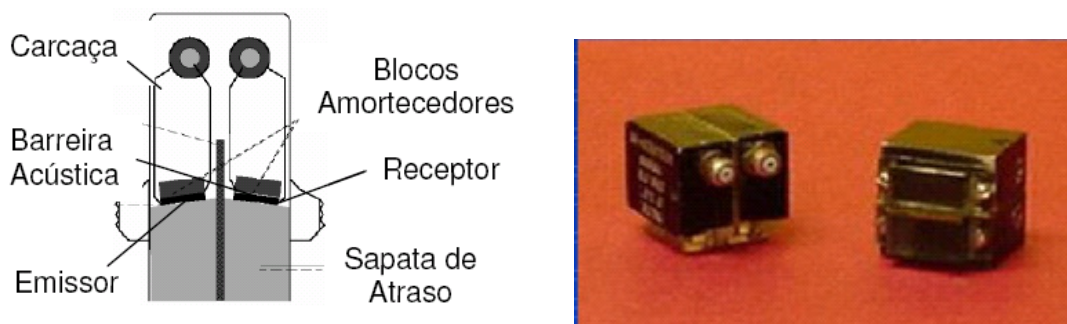
Figura 3.30: Figura esquemática de um cabeçote duplo-cristal e ao lado um exemplo deste tipo de cabeçote [13][19]
