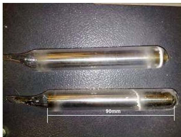
Figura 4.2 - Amostras de HGO encapsuladas em tubo de quartzo
