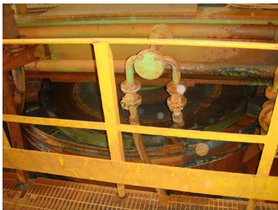
Figura 3.15. WHIMS de Brucutu (Arquivo particular do autor, 2008).
