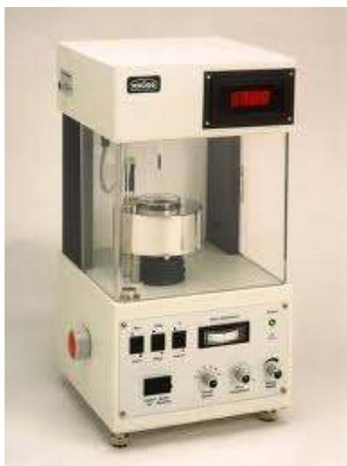
Figura 4.3. Tensiômetro Krüss K10ST (Krüss, 1991).
