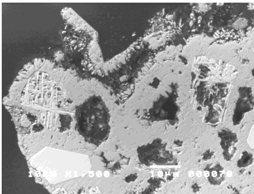
Figura 5-7 – Amostra 5/14 concentrado. Seção polida. MEV, IER. Partícula com feições diversas, com hematita martítica porosa, goethita botrioidal porosa, goethita terrosa e pouca hematita lamelar. Poros variando de 15,0μm a 1,0μm.
