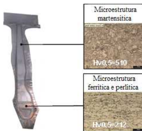
Figura 1.8 Coluna B em escala reduzida desenvolvida pela ArcelorMittal estampada a quente com propriedades mecânicas sob medida.
