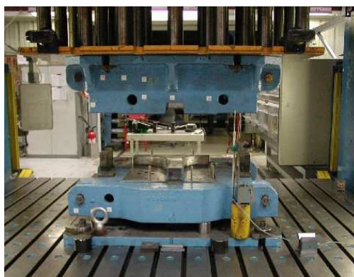
Figura 7.14 Prensa hidráulica para estampagem da coluna B (ArcelorMittal Montataire).
