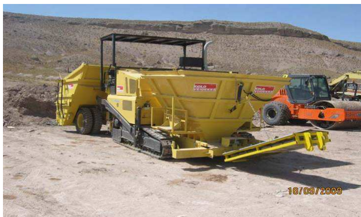
Figura 2.13: Foto da máquina pavimentadora (Protz, 2012).
