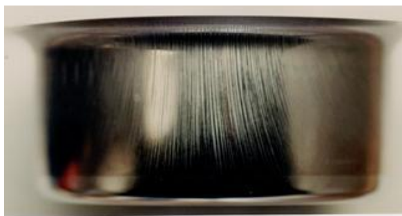
Figura 3.17: Fenômeno de estriamento em um aço inoxidável ferrítico [30] .
