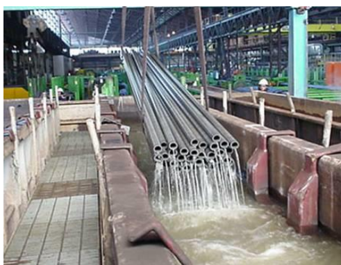
Figura 4:6: Tanque de preparação química.
