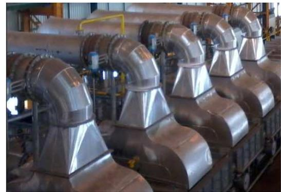
Figura 4.8 – Seções do forno de recozimento da CGL#2. (a) aquecimento por tubos radiantes; (b) encharque por resistências elétricas; (c) e (d) resfriamento por *Jet-Cooler*.
