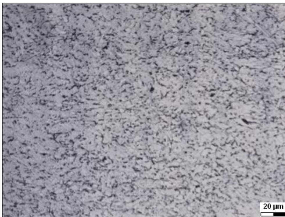
Figura 3.6 – Ampliação de 500X no MO do aspecto microestrutural de bobina de aço X80 (0,08%C-1,59%Mn-0,35%Si-0,24%Cr-0,12%Mo-0,028%Al-0,070%Nb-0,046%V-0,015%Ti) (15)
