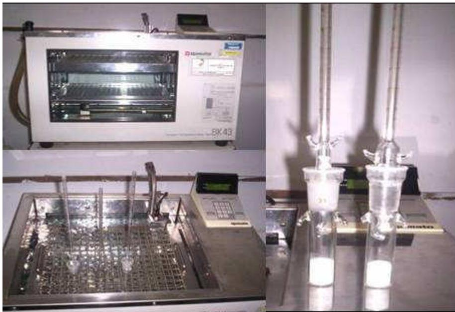
**Figura 5.2** – Equipamentos de determinação do “gassing” em pó de zinco.
