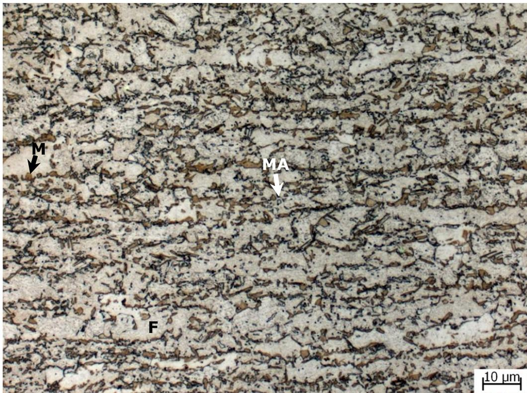
(b) Microscopia óptica. Ataque colorido (DE *et al.*, 2003).
