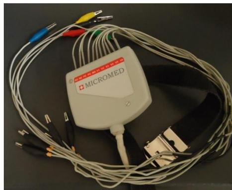
FIGURA 2: Eletrocardiógrafo *Micromed<sup>®</sup>*
