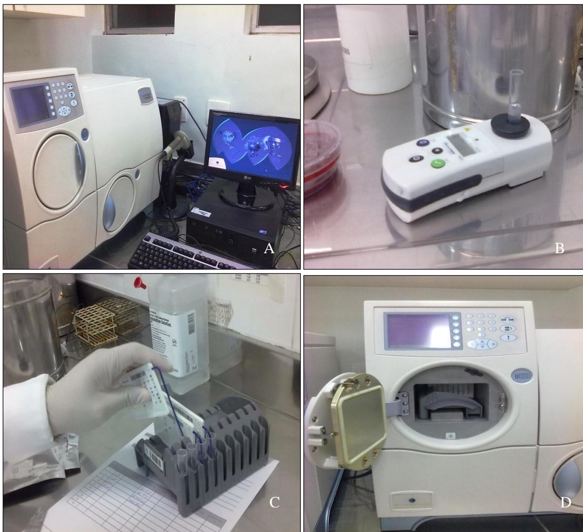
Figura 8 - Identificação confirmatória da espécie de Neisseria gonorrhoea no equipamento VITEK®2. A- Equipamento VITEK®2; B- Leitura da turbidez do inóculo no Densichek; C- Cartão de identificação NH sendo acoplado à suspensão bacteriana padronizada; D- Cartão sendo inserido no equipamento.
