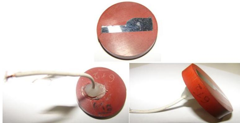
Figura 19: Amostra embutida com fio de cobre soldado.
