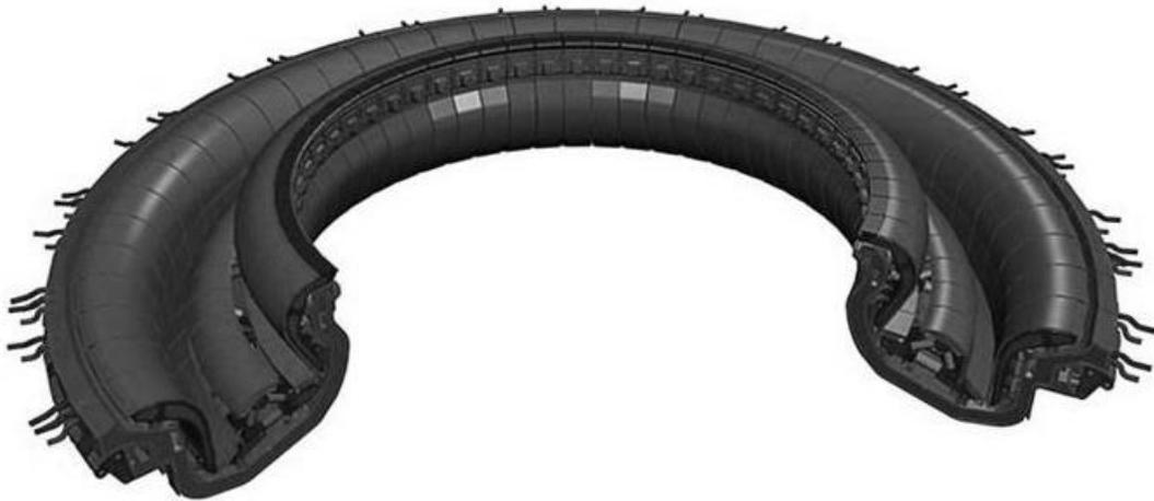
Figura 5 - Sistema diversor do ITER.
