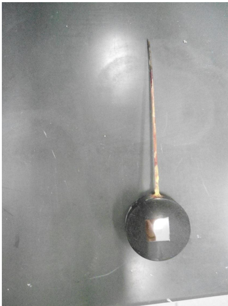
Figura 4-3- Modelo do eletrodo de trabalho utilizado para os ensaios eletroquímicos. A figura 4.4 ilustra a célula eletroquímica utilizada para os testes eletroquímicos.
