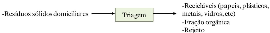
**FIGURA 12: Esquema das usinas de triagem**
