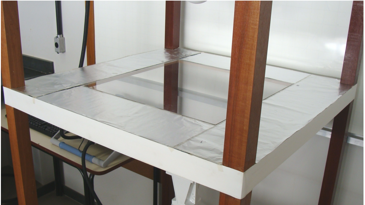
Figura 6.10: Moldura metálica revestindo a região ao redor da amostra. No caso desta foto, a amostra de acrílico está colocada no suporte.
