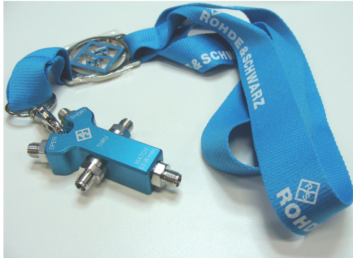
Figura 4.10: Kit de Calibração 3.5 mm fêmea, modelo ZV-Z135, da Rohde & Schwarz.
