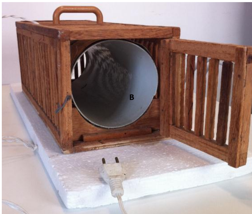
FIGURA 4 – Bobina (B) no interior da gaiola.
