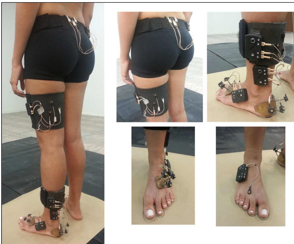
Figura 4 – Clusters com marcas de rastreamento conectadas a baterias para os segmentos pelve, coxa, perna, retropé e antepé. Uma marca ativa adicional foi colocada no pé contralateral para definição do evento término da descida do degrau.
