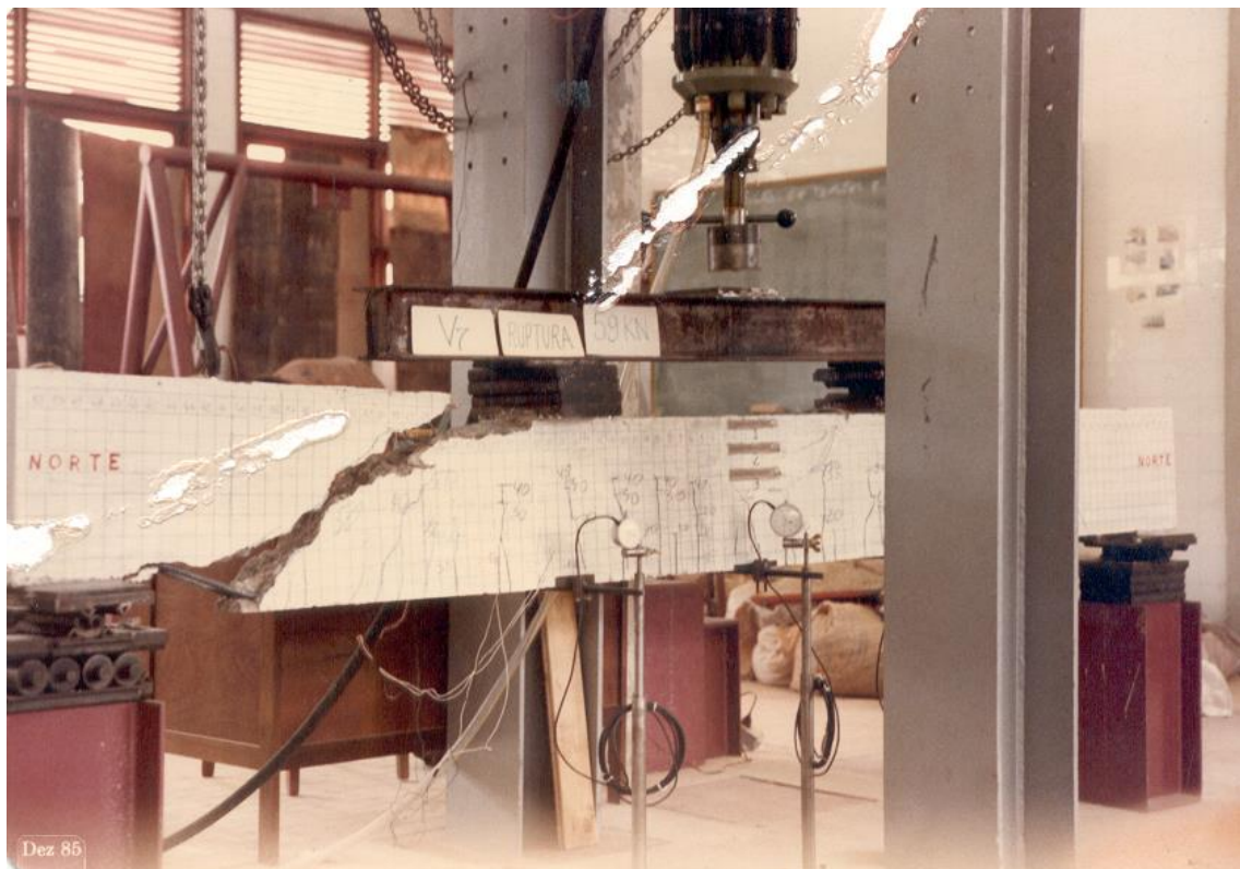
FIGURA 2.5 – Ruptura por tração diagonal em uma viga de concreto armado. Fonte: www.dec.ufcg.edu.br (acessado em novembro, 2012).
