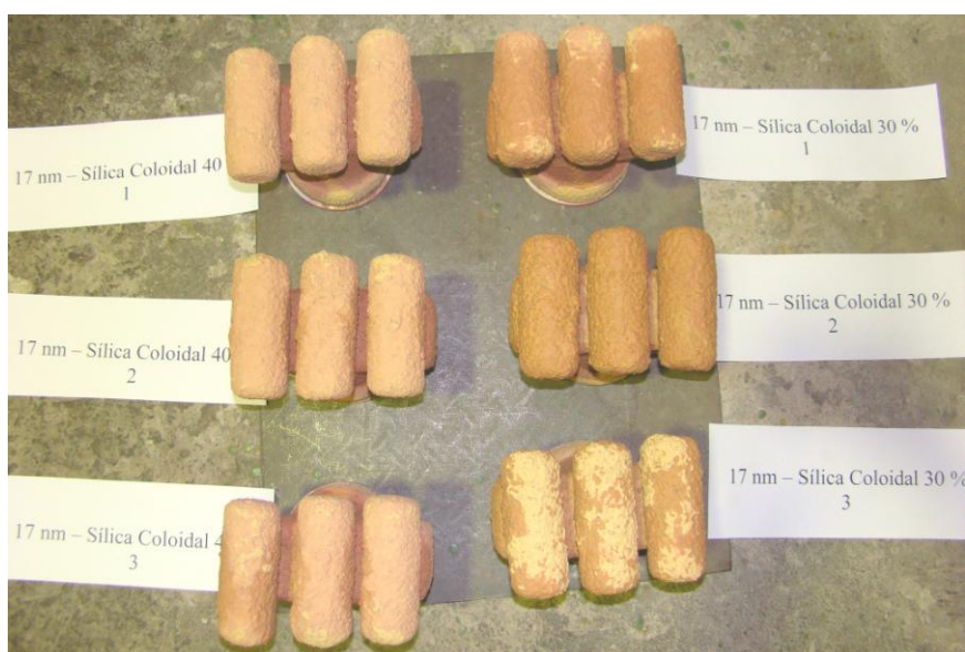
Figura 5.46 – Moldes de cilindros em casca cerâmica contendo sílica coloidal de 14 a 20nm (identificado por 17nm), após o término do teste de escoamento de líquido penetrante.
