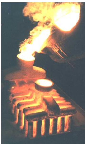
Figura 3.4 – Vazamento de casca cerâmica – processo de fundição de precisão Acervo: PDI – SENAI/CETEF (1998).
