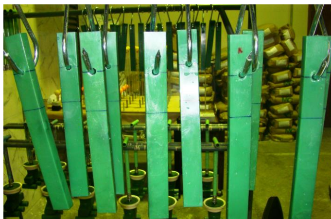
Figura 4.3 – Barras de cera para confecção dos corpos de prova para ensaio de flexão.
