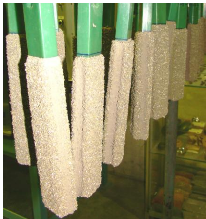
Figura 4.6 – Processamento das camadas de cascas cerâmicas para ensaio de resistência à flexão.
