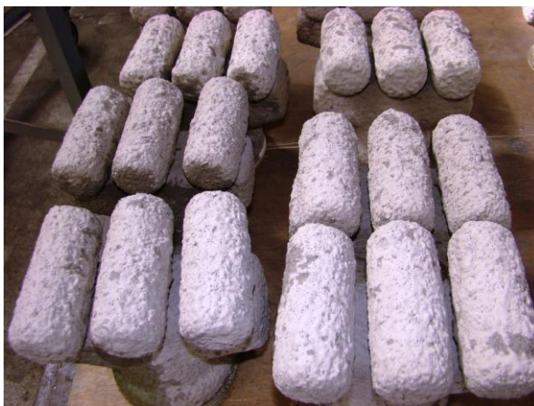
Figura 4.14 – Moldes em cascas cerâmicas após deceragem para testes com base no ensaio de Hendricks et al (1999; 2007).
