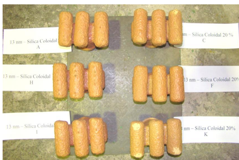
Figura 5.43 – Moldes de cilindros em casca cerâmica contendo sílica coloidal de 13nm, após o término do teste de escoamento de líquido penetrante.
