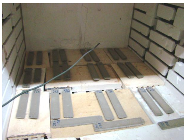
Figura 4.9 – Corpos de prova e termopar posicionados no forno de sinterização.
