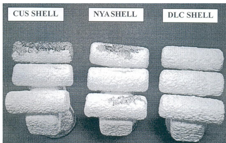
Figura 3.22 – Fotografia de 03 moldes após deceragem, sinterização e passagem de um líquido penetrante (HENDRICKS et al, 2007).
