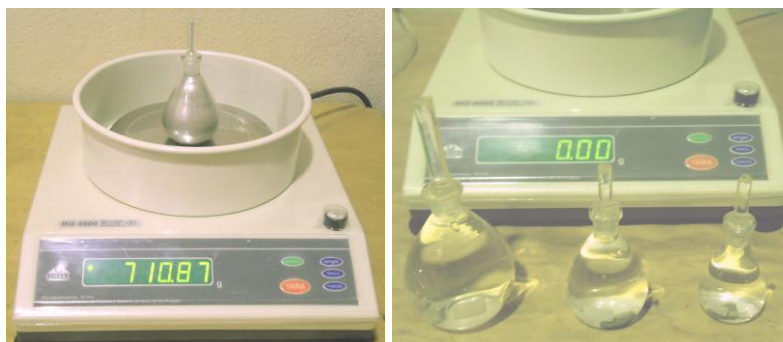
Figura 4.15 – Determinação das densidades volumétrica (à esquerda) e aparente (à direita).
