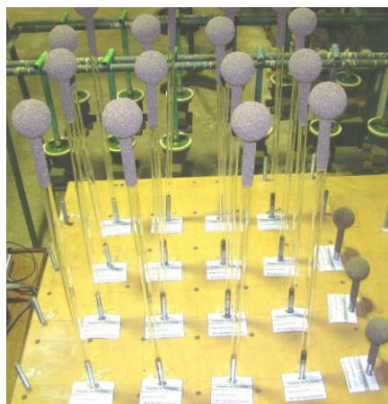
Figura 4.7 – Processamento das camadas de cascas cerâmicas para ensaio de Permeabilidade.
