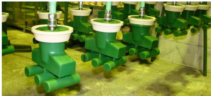
Figura 4.5 – Cachos de cilindros de cera para confecção dos corpos de prova para ensaio de resistência à deceragem - método proposto por Hendricks et al (1999; 2007).
