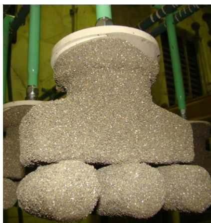
Figura 4.8 – Processamento das camadas de cascas cerâmicas para ensaio de resistência à deceragem.
