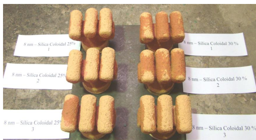
Figura 5.44 – Moldes de cilindros em casca cerâmica contendo sílica coloidal de 8nm, após o término do teste de escoamento de líquido penetrante.
