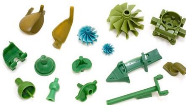
Figura 3.1 – Modelos em cera para peças fundidas ( HTTP://WWW.INVESTMENTCASTINGWAX.COM ).
