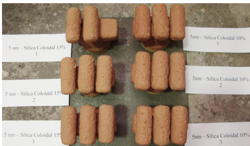
Figura 5.45 – Moldes de cilindros em casca cerâmica contendo sílica coloidal de 5nm, após o término do teste de escoamento de líquido penetrante.
