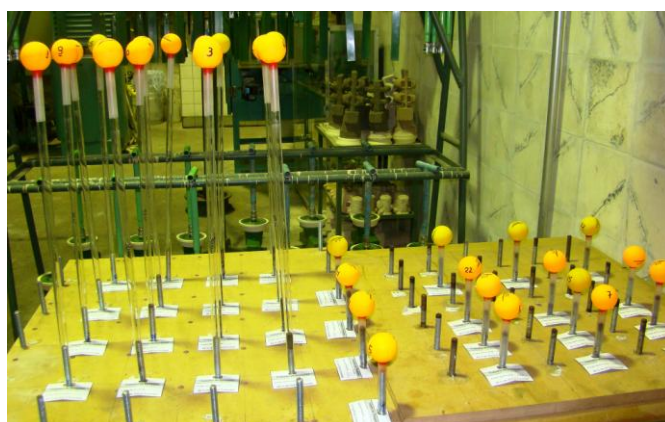
Figura 4.4 – Tubos de quartzo com bolinhas de pingue-pongue para confecção dos corpos de prova para ensaio de permeabilidade a quente (tubo maior) e a frio (tubo menor).
