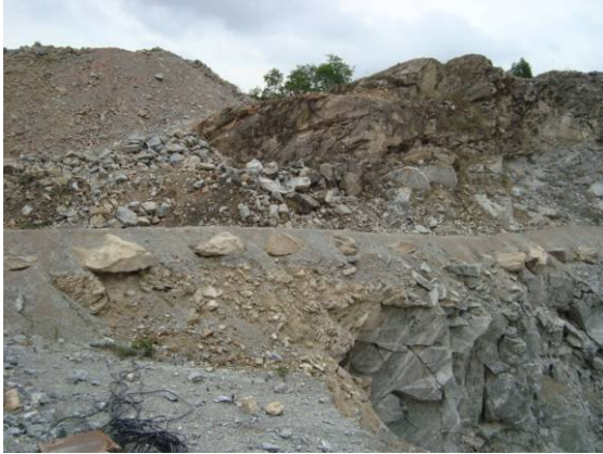
Figura 3.5 – Corte do maciço rochoso na extremidade leste da cava, demonstrando o mergulho do bandamento gnáissico.
