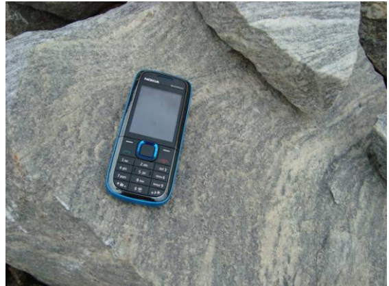
Figura 3.8 – Detalhe da figura anterior com detalhe da petrografia (bandamento gnáissico).
