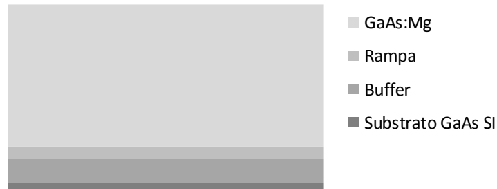
Fig. 29: Perfil dos filmes finos crescidos por MBE para o presente estudo. A espessura da camada de GaAs dopada com Mg é d = 2.04\mu\text{m} .
