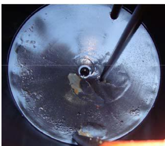
Figura 15 – Tanques de postos de combustíveis sob ação da oxidação do B5 (VIEIRA, 2010).
