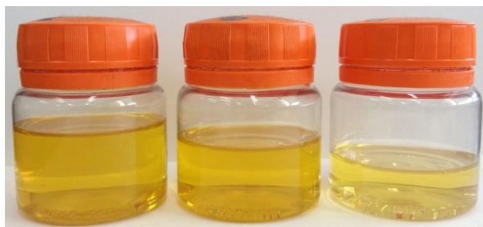
Figura 56 – Imagem da solução B25 após a imersão das chapas A, B e C, respectivamente.
