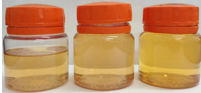
Figura 51 – Imagem da solução E50 após a imersão das chapas A, B e C, respectivamente.
