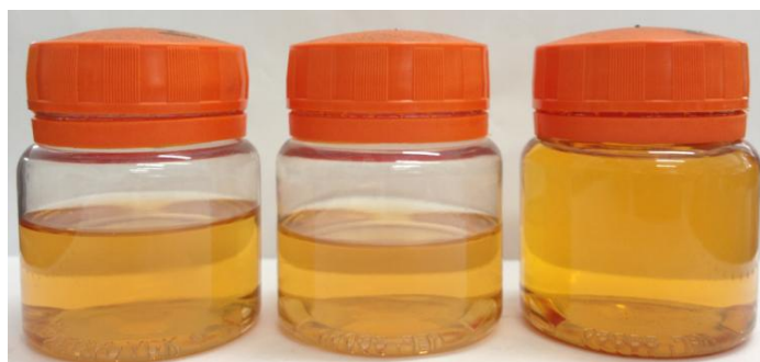
Figura 50 – Imagem da solução E20 após a imersão das chapas A, B e C, respectivamente.
