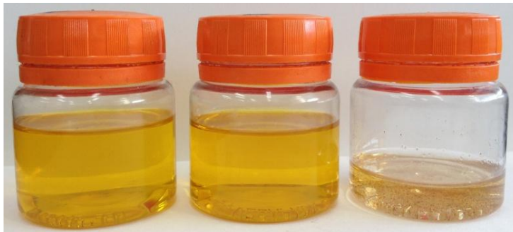
Figura 59 – Imagem da solução B100 após a imersão das chapas A, B e C, respectivamente.
