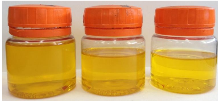
Figura 58 – Imagem da solução B75 após a imersão das chapas A, B e C, respectivamente.
