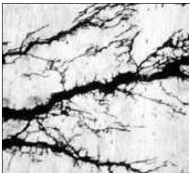
Figura 11 – Corrosão Intragranular em latão (MAINIER, 2011).
