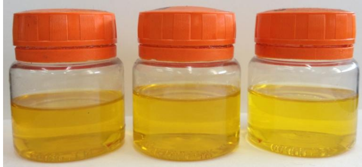
Figura 57 – Imagem da solução B50 após a imersão das chapas A, B e C, respectivamente.
