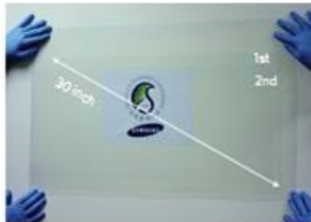
Figura 1.2 – Foto de um filme de Grafeno de 30 polegadas transferido para um filme plástico transparente [16].
