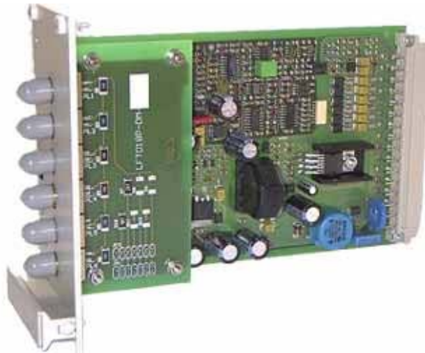
Fig. 68 - Circuito de Disparo de Tiristores a Luz
