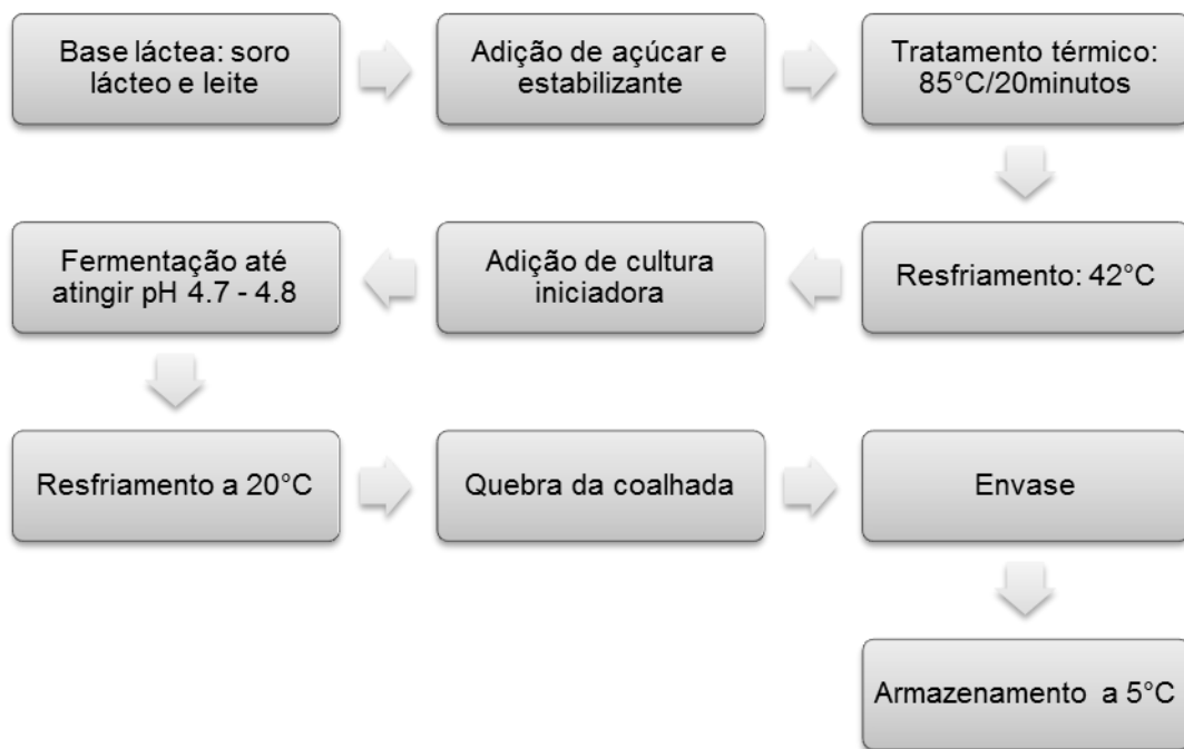
Figura 2: Fluxograma de produção das bebidas lácteas fermentadas. Adaptado de (THAMER & PENA, 2006; SACCARO, 2008).
