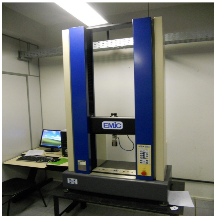
FIGURA 37 – Máquina de ensaios universal da empresa EMIC.
