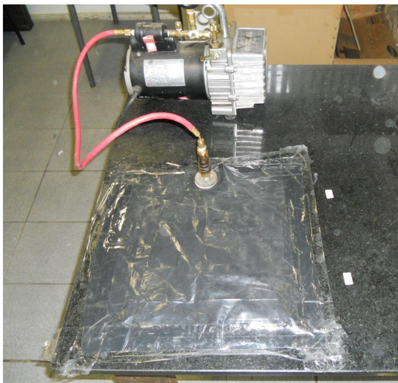
FIGURA 36 – Aparato de cura dos compósitos: bomba de vácuo ligada a uma bolsa de vácuo.
