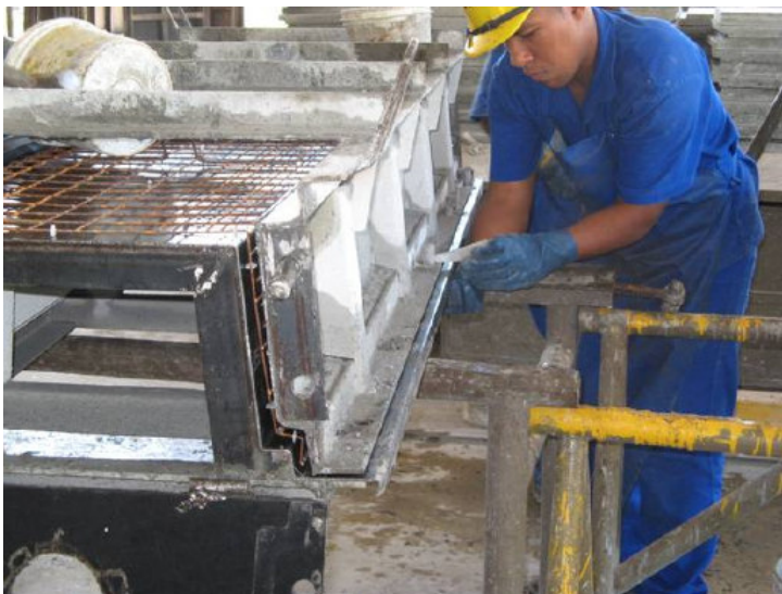
Figura 43. Forma dupla de componentes de argamassa armada Fonte: Trigo, 2009: 60.
