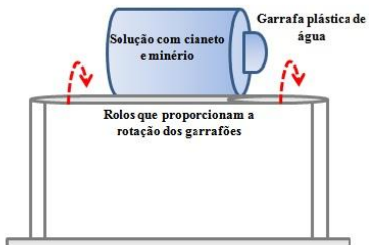
Figura 5.6 - Representação esquemática do sistema de garrafões.
