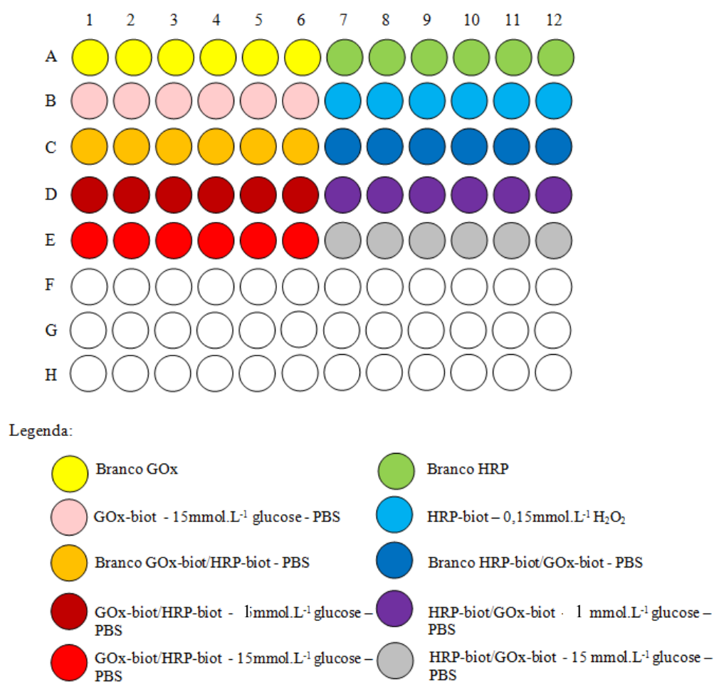
Figura 4.12 – Esquema do uso de microplacas para monitoração da atividade das estruturas bienzimáticas em PBS.
