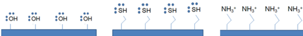
Figura 5.16 – Representação esquemática das superfícies funcionalizadas quando da aplicação do glutaraldeído, funcionalização hidroxila (a), tiol (b) e amina (c).
