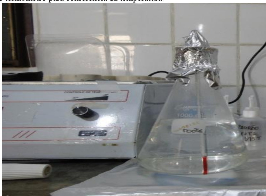
FIGURA 3.1. - Água utilizada para a preparação do diluidor em erlenmeyer e termômetro para conferência da temperatura
