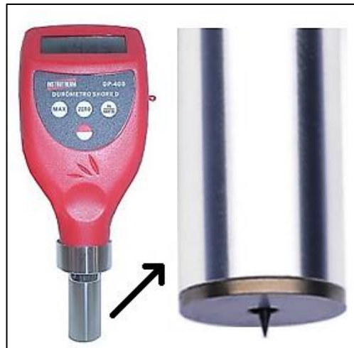
FIGURA 3 – Durômetro “shore D” portátil modelo DP-400 INSTRUTHERM® (Fonte: http://www.instrutherm.com.br ).
