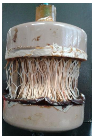
Figura 4.2 - Módulo de ultrafiltração utilizado durante a filtração do vinhoto bruto
