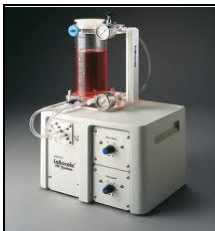
Figura 18 – Ilustração do cassete de filtração Millipore Pellicon® XL 50 acoplado ao sistema de filtração de fluxo tangencial Millipore Labscale®.
