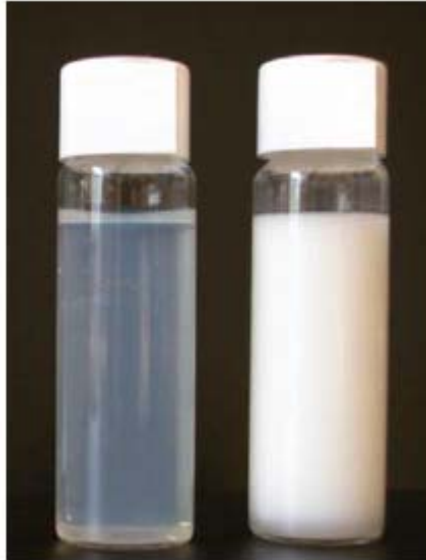
Figura 7 – Fotografia de uma NE (à esquerda) e uma macroemulsão (à direita), com tamanho de glóbulos de 35 nm e 1 \mu m, respectivamente (Solans et al. , 2005).
