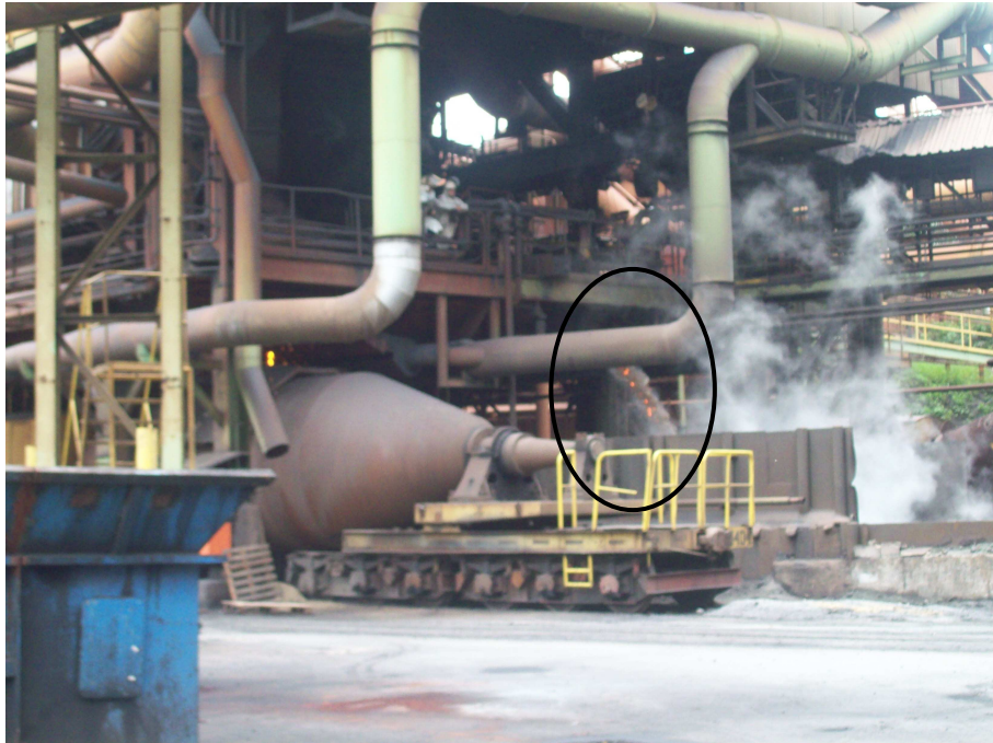
Figura 7: Processo de Transporte do Ferro Gusa para a Aciaria Autor: Ana Lúcia Félix. Nov, 2010.
