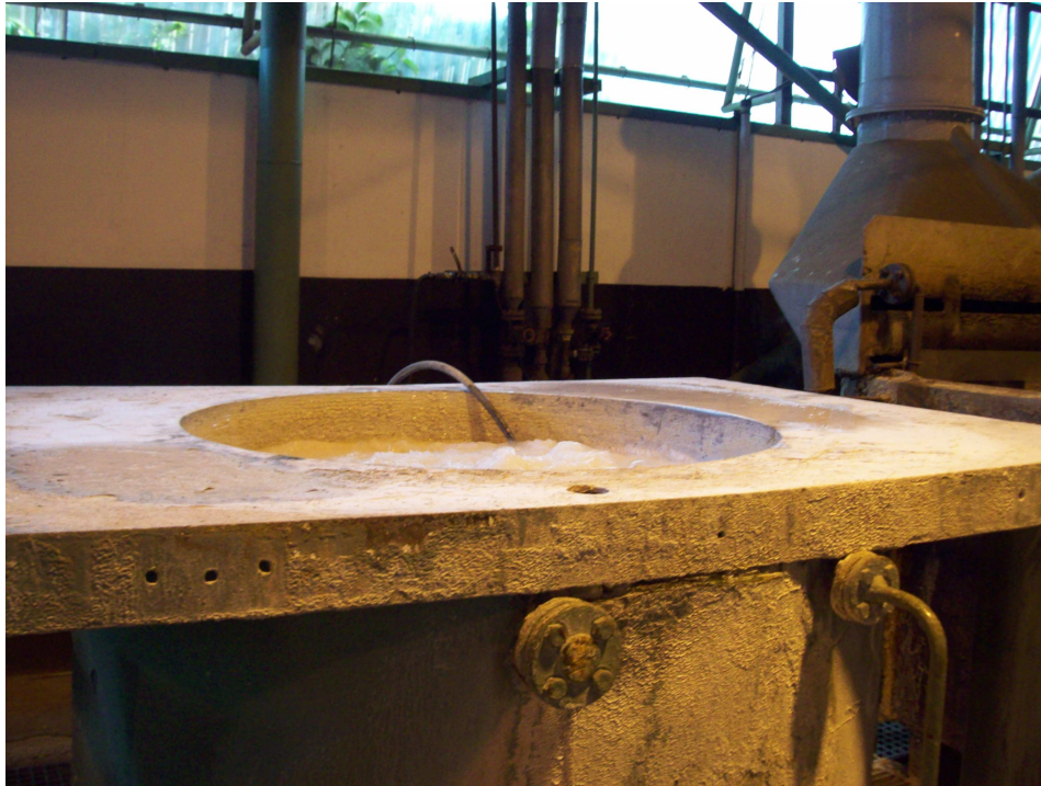
Figura 12: Tanque de fosfatização (fosfato de manganês) Autor : Ana Lúcia Félix. Nov, 2010.
