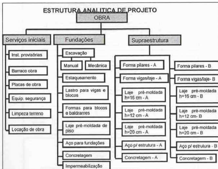
Figura 04 – Estrutura Analítica de Obra (parcial)
