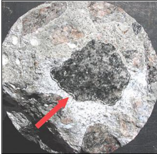
Figura 3.14: Borda formada a partir da reação, circundando o agregado. Fonte: (< http://www.revistatechne.com.br/engenharia-civil/125/imprime59011.asp > Acessado em 26/01/2012, às 20:41:45)
