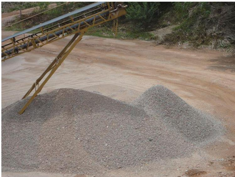
FIG 10-Agregados dos resíduos da construção civil
